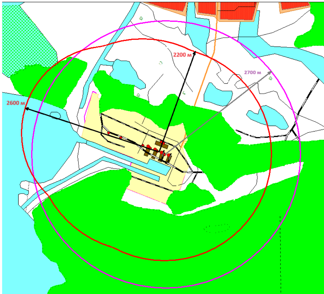
Рисунок 5.15 – Межі санітарно-захисної зони Хмельницької АЕС, визначені в результаті проведених розрахунків згідно з вимогами СОУ НАЕК 023:2014 [55] (червоним кольором). Фіолетовим кольором показано існуючі межі СЗЗ ХАЕС у вигляді кола з радіусом 2700 м.
